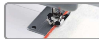
punto di copertura
