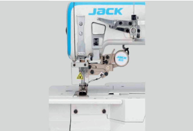
1 Pinzafile Dispositivo per trattenere i fili tagliati.
