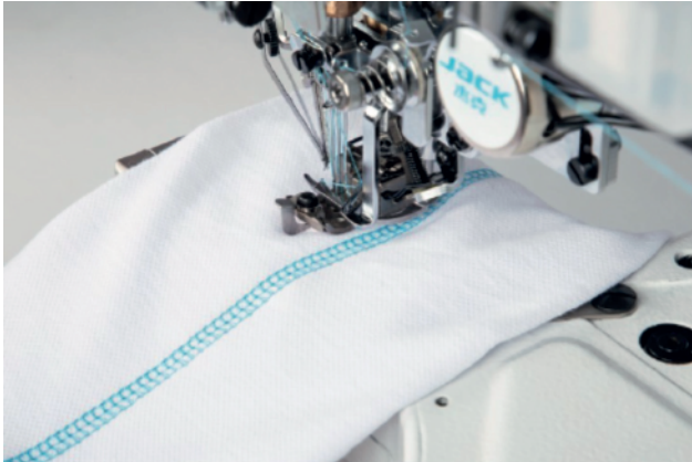
2 Alta Velocità La velocità della W4 è di 5.500 rpm, rispetto ai 3.700 rpm di una normale macchina con copertura, l'efficienza aumenta più del 50%.
