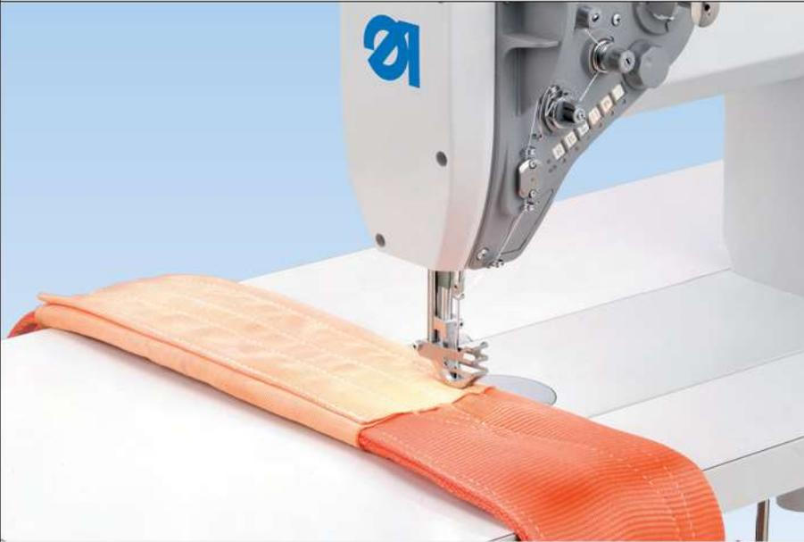
Der große Stichlängenbereich, der kraftvolle Materialtransport und die enorme Durchstichkraft der H-TYPE sind die idealen Voraussetzungen zum Vernähen von Schwerlastgurten.
