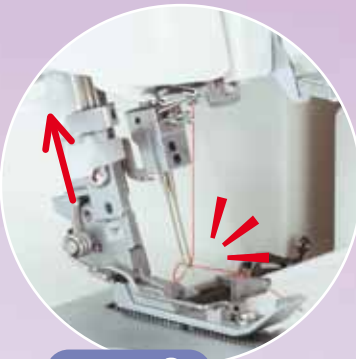
Etape 3 Ramener le levier en position haute. C'est terminé ! votre aiguille est enfilée!
