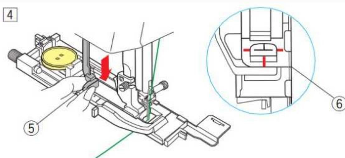
5) La boutonnière sera cousue automatiquement en suivant la procédure indiquée. Une fois la boutonnière terminée, la machine s'arrêtera automatiquement avec l'aiguille en position relevée. Appuyez sur la touche coupe-fil et retirez le tissu.
