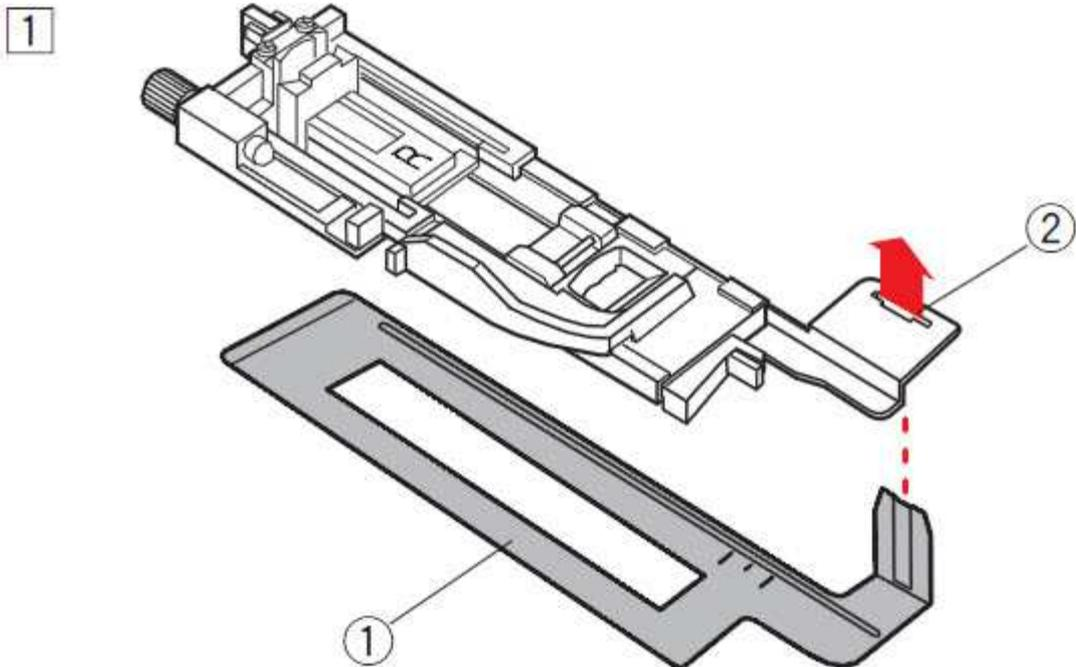
2) Placez bouton sur le porte-bouton situé sur le pied. Fixez le pied de la boutonnière sur la machine. Insérez un tissu entre le pied de la boutonnière et la plaque stabilisatrice. Tirez le fil de l'aiguille vers la gauche entre le pied et la plaque de stabilisateur.
