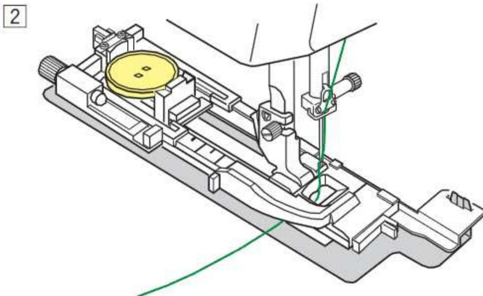
3) Placez le tissu entre le pied de la boutonnière et la plaque stabilisatrice. Abaissez l'aiguille dans sa position de départ en tournant le volant. Abaissez le pied et le levier de la boutonnière. Démarrez la machine tout en tirant le fil de l'aiguille légèrement vers la gauche. Après avoir cousu quelques points, relâchez le fil et continuez à coudre.
