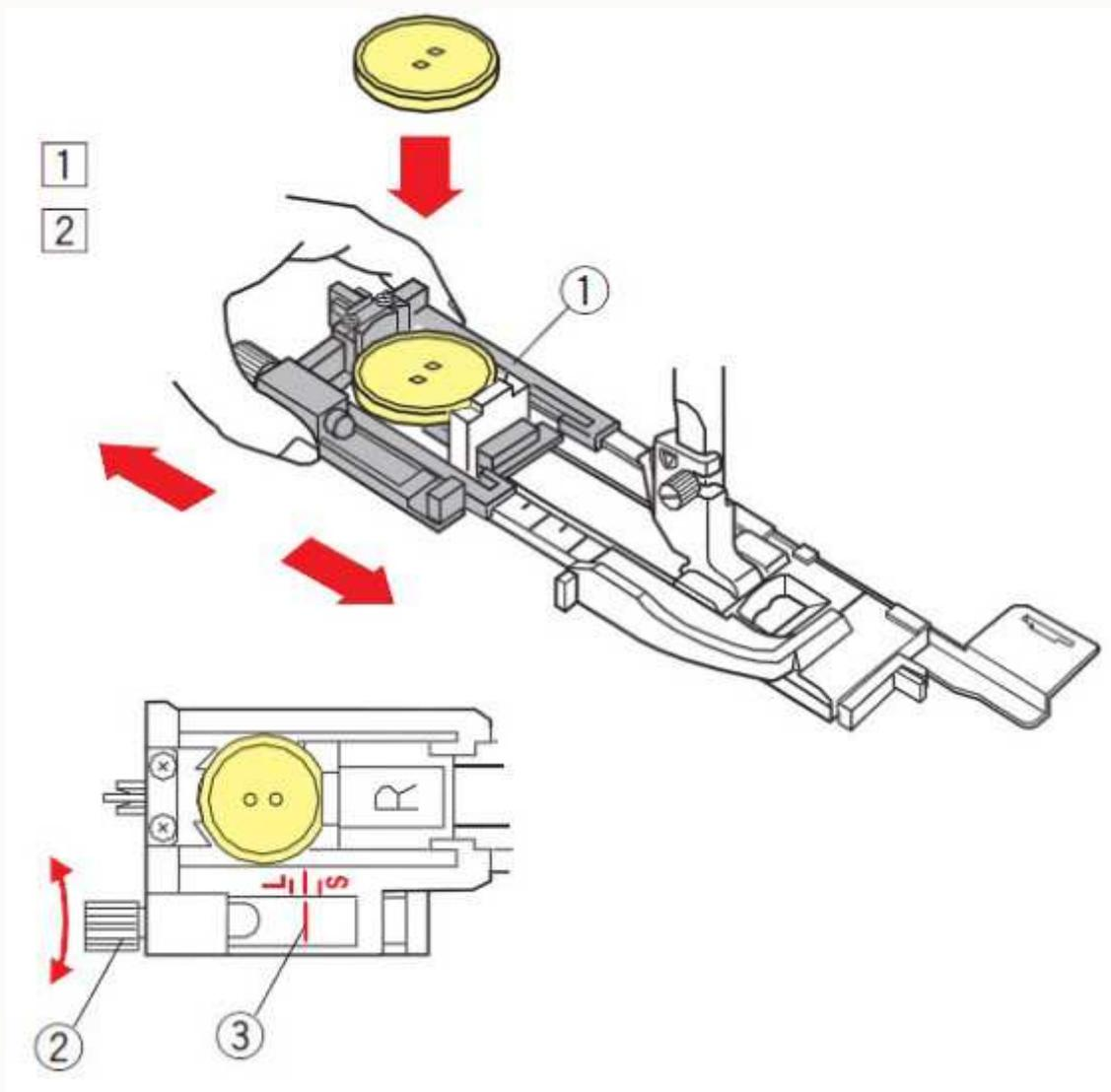
3) Tirez le fil de l'aiguille vers la gauche dans le trou du pied. Tracez la position de la boutonnière sur le tissu, puis placez-le sous le pied de boutonnière. Abaissez l'aiguille au point de départ en tournant le volant.
