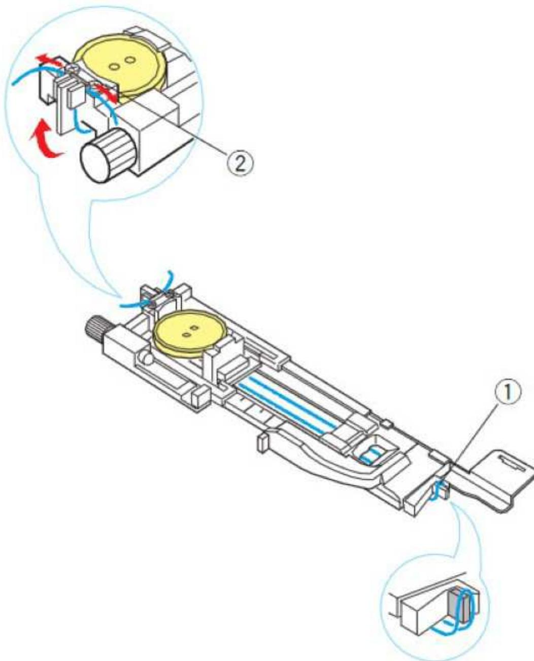
Abaissez l'aiguille dans le tissu là où doit commencer la boutonnière. Abaissez le pied et le levier de la boutonnière. Démarrez la machine pour piquer la boutonnière par-dessus le cordonnet. La machine s'arrête automatiquement lorsqu'elle a terminé.
